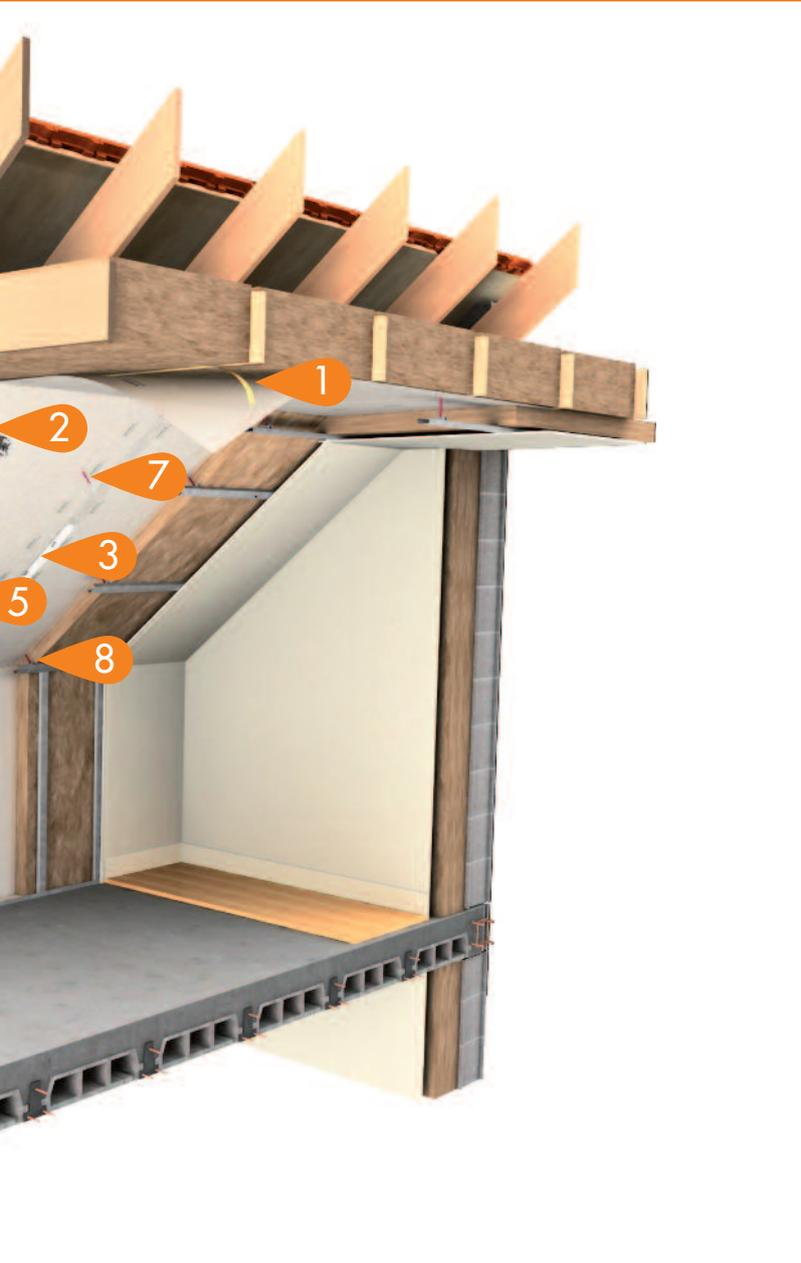
**5** Raccordement sur tuyau à l'aide de la manchette universelle et de l'adhésif Solifit
