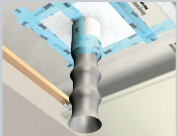
**7** Raccordement de la membrane sur trappe de visite étanche à l'aide de l'adhésif Solifit
